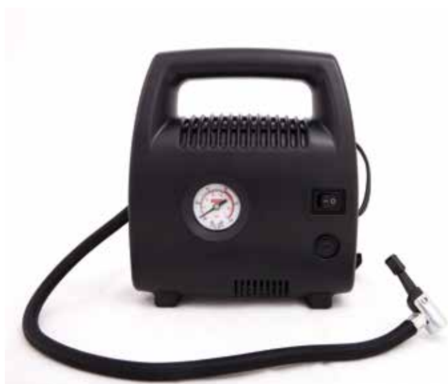
900 900 Compresor pequeño. Tensión: 230V. Frecuencia: 50HZ. Máx. presión 80psi. Potencia: 85w. No tiene termostato. Trabajar durante 10 minutos y descansar durante 10 minutos. Voltage: 230V. Frequency: 50HZ. Max pressure 80psi. Rated power input: 85watt. Allow pump to cool for 10 minutes after each 10 minutes of continuous use.
